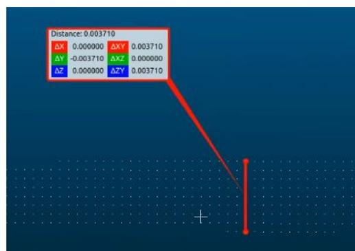
(d) Width of crack
