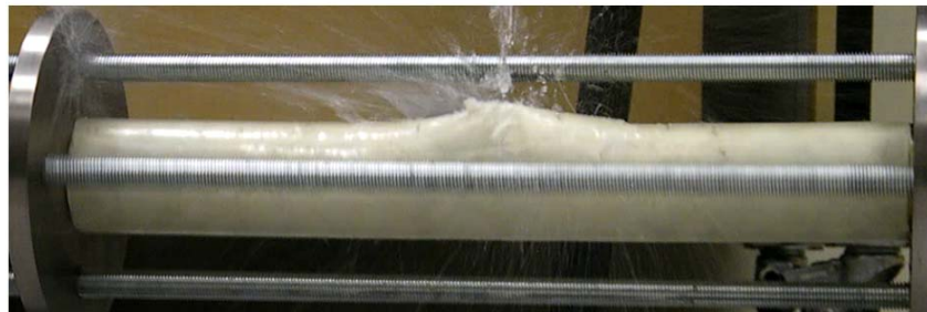
(b) Actual burst of hybrid composite pipe
