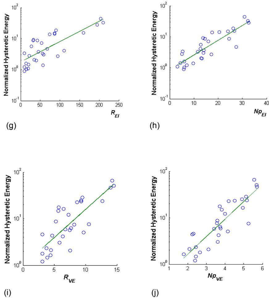
Fig. 3. Prediction of normalized hysteretic energy for the steel frame F4 with  $T_1=0.90s$  ( $Sa(T_1)=1000cm/s^2$ ) for: (a)  $PGA$ ; (b)  $PGV$ ; (c)  $I_D$ ; (d)  $t_D$ ; (e)  $R_{Sa}$ ; (f)  $N_{pSa}$ ; (g)  $R_{EI}$ ; (h)  $N_{pEI}$ ; (i)  $R_{VE}$  and (j)  $N_{pVE}$
