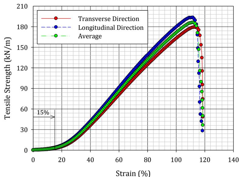
Fig. 2. PP Geotextile Tensile-Strain Curve
