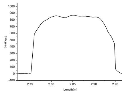
(d) Strain distribution with 3mm adhesive layer thickness
