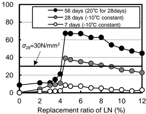
**Fig.6** Compressive strength (-10° C)
